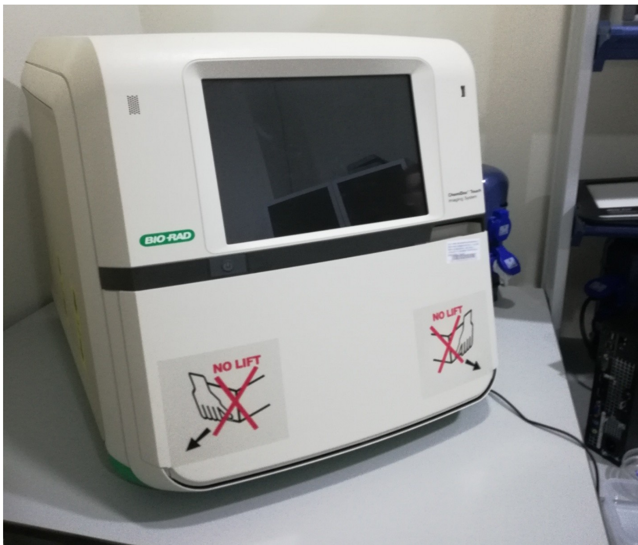
Рисунок Б.3 – Система анализа и документирования результатов 1- и 2-D электрофореза ChemiDoc Touch
